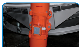
Motorisation par 2 vibrateurs diamétralement opposés (Atex 22)
