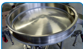
Produktberührende Teile aus Edelstahl 1.4301
