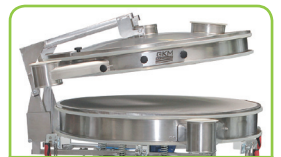
Pneumatisch öffnender Deckel
